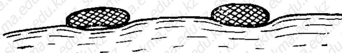
Сурет-2. Су бетінде жүзіп жүретін флотационды кен бөлшектері.
